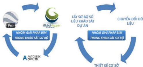
Hình 7. Đề xuất nhóm giải pháp BIM trong giai đoạn khảo sát sơ bộ cho dự án hạ tầng giao thông
